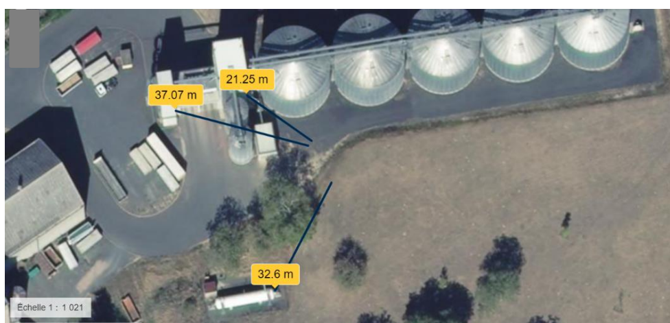
Distances des éléments existants par rapport à la cellule la plus proche
