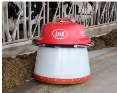
Figure 73 : Robot pousseur LELY Juno 100
