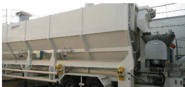
Illustration n° 9 : Silo à filler d'une centrale
