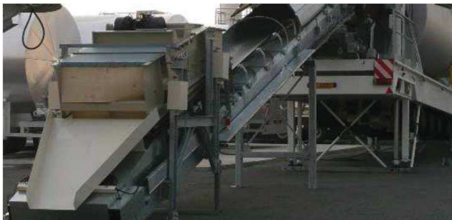
Illustration n° 11 : Ecrêteur vibrant d'une centrale
