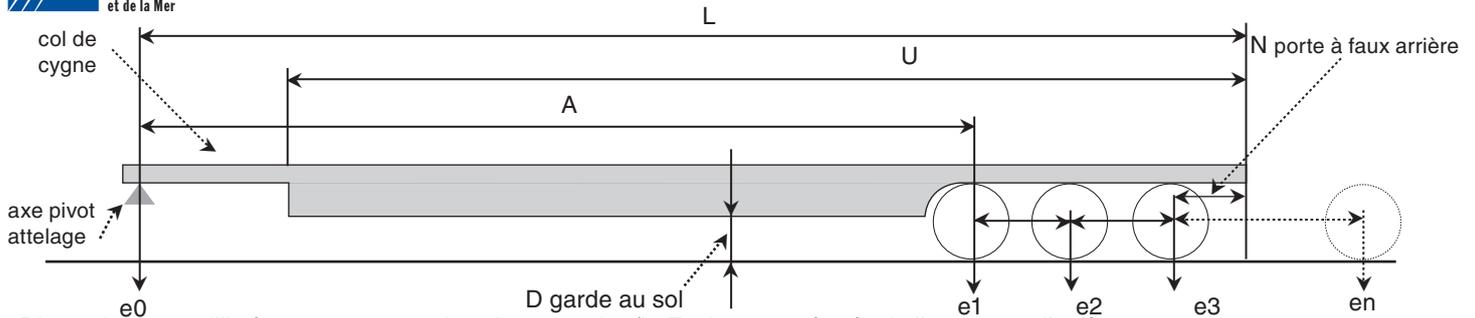
Dimensions en millimètres, masses en kg, vitesse en km/h. Essieux numérotés de l'avant vers l'arrière
