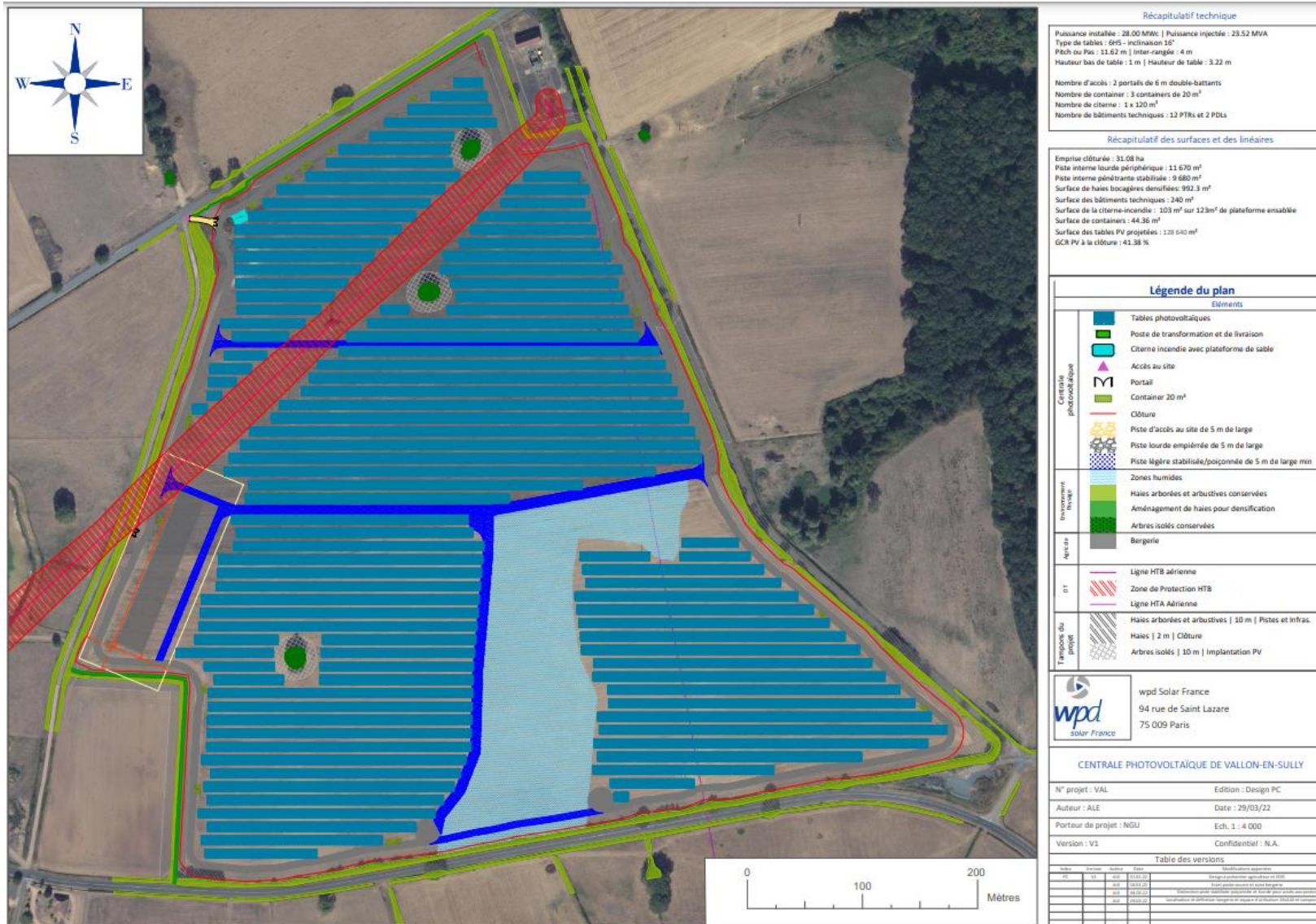
Figure 3 : Plan de masse et caractéristiques du projet agrivoltaïque de Vallon en Sully
