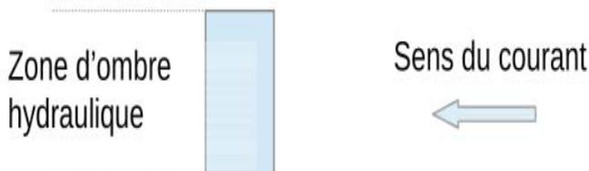
Zone située à l'arrière d'un bâtiment ou ouvrage existant par rapport au sens du courant. Le fait d'implanter un bâtiment dans l'ombre hydraulique d'un autre bâtiment limite son effet d'obstacle à l'écoulement.
