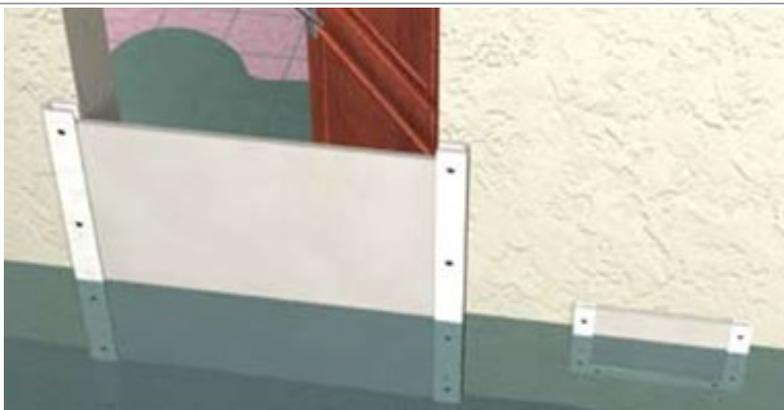
La stabilité des murs en maçonnerie de qualité courante peut être menacée dès lors que la différence de hauteur d'eau entre l'intérieur et l'extérieur atteint un mètre. Ceci conduit à limiter la hauteur des batardeaux à un mètre.
